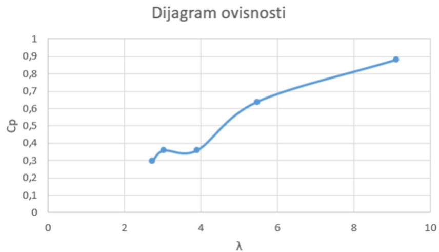
Slika 5.1. Rezultati vjetroturbine s pravkutnom domenom [10]
