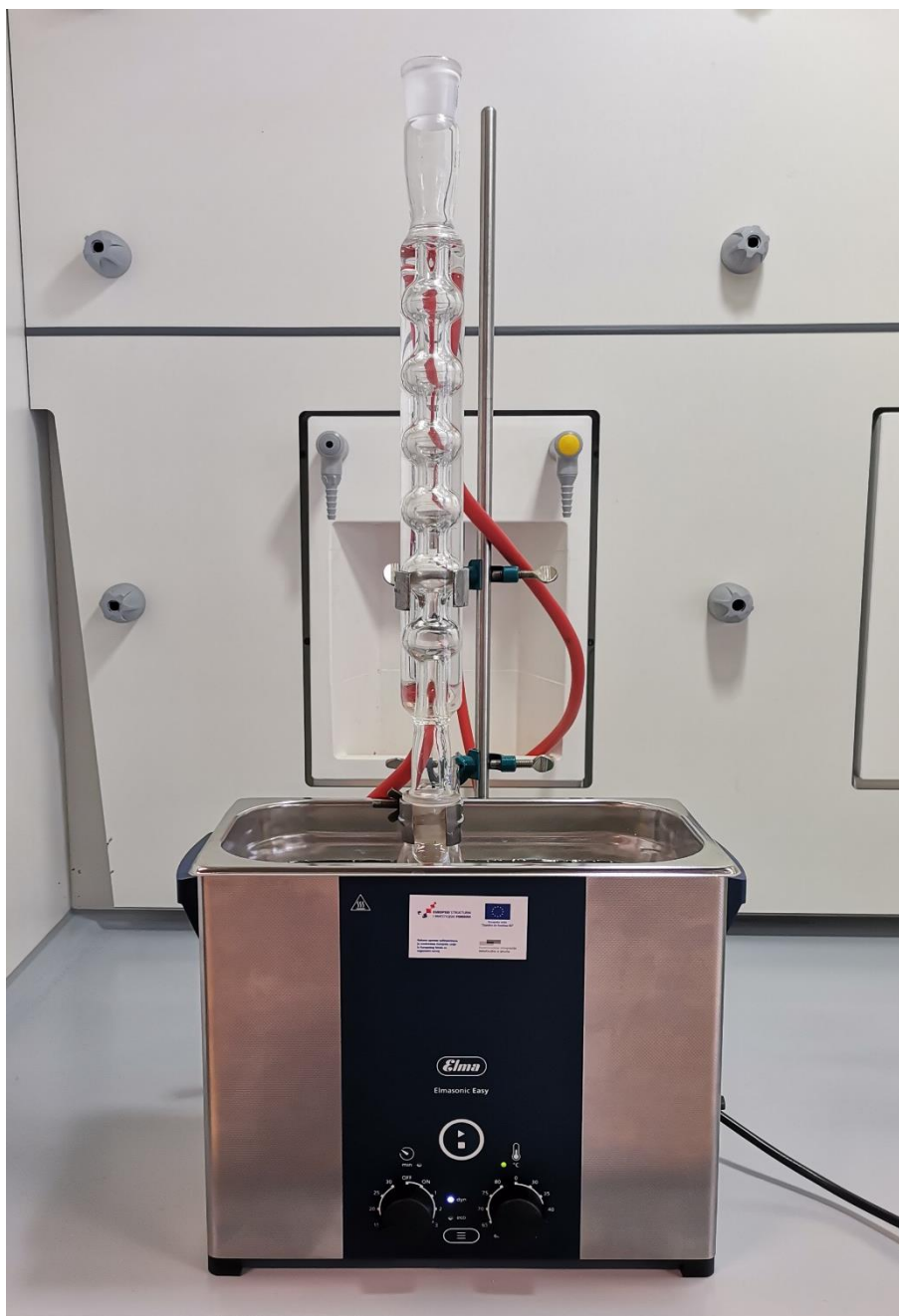
Slika 4: Pripremljena aparatura za ultrazvučnu ekstrakciju
