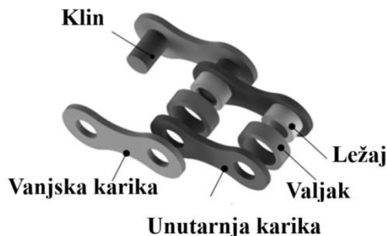
Slika 2.1 Shematski prikaz valjkastog lanca [12]
