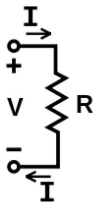
Slika 2.3.  $V(U)$ ,  $I$  i  $R$ , parametri Ohmovog zakona. Struja  $I$  uslijed razlike potencijala  $U$  teče kroz otpor  $R$ . [6]
