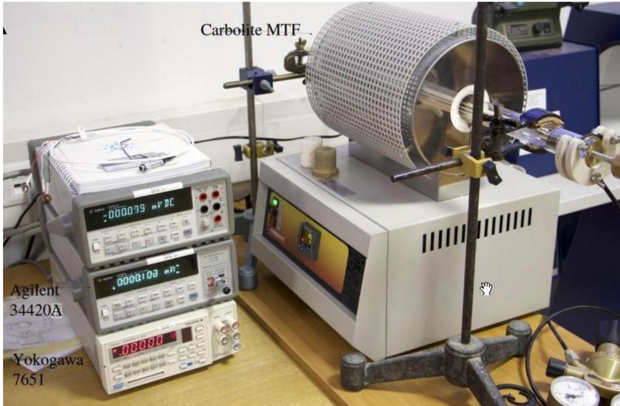
Slika 3.3. Eksperimentalni aparat; korištena je peć/temperaturni kontroler Carbolite MTF, naponski izvor/nanovoltmetar Agilent 344201 te strujni izvor – Yokogawa 7651. Uzorak se nalazi na na nosaču unutar staklene cijevi te je umjetnut u peć. [10]
