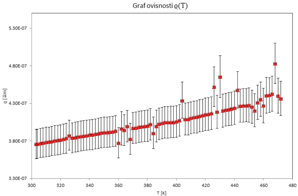
Slika 4.1. Eksperimentalno dobiveni graf ovisnosti električne otpornosti o temperaturi za kvazikristal *d*-AlCoNi u periodičnom smjeru. Odstupanja pojedinih točaka su objašnjena u poglavlju 4. Zaključak.
