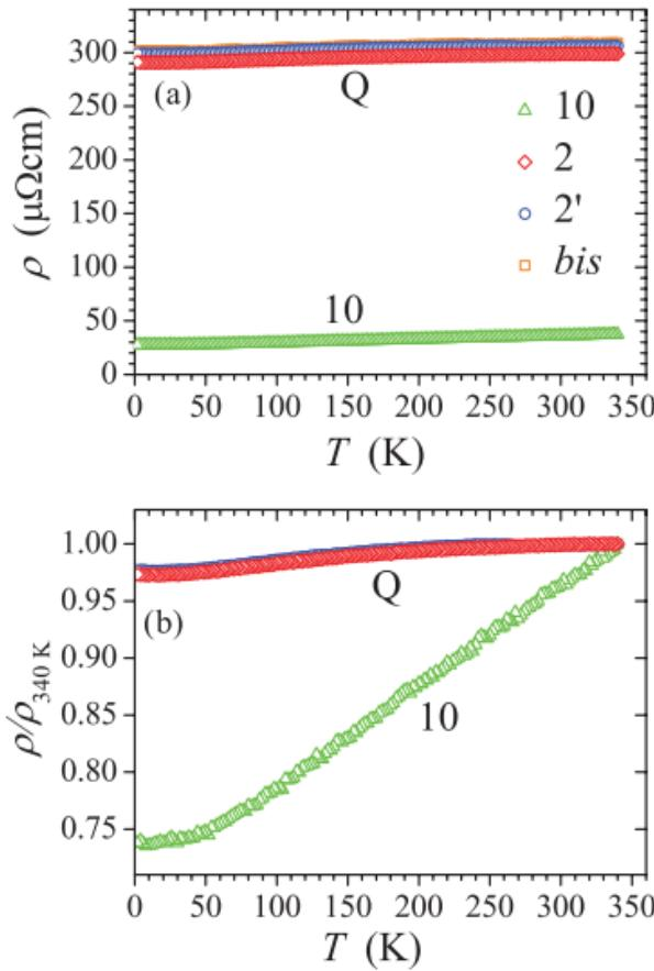
Slika 2.6. Temperaturna ovisnost električne otpornosti  $\rho(T)$  dekagonalnog kvazikristala *d*-AlCoNi. Pravac s oznakom „10“ predstavlja periodični smjer. Gornji graf predstavlja absolutnu vrijednost električne otpornosti u ovisnosti o temperaturi, dok je donji graf skaliran na njezinu vrijednost na 340 K [2].
