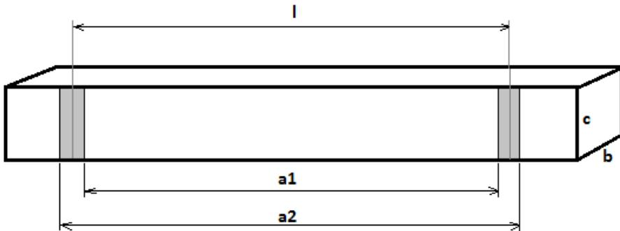
Slika 3.1. Shematski prikaz geometrijskih karakteristika uzorka. Zasivljena područja pojednostavljeno prikazuju područje naponskih kontakata. Kao duljina  $l$  pri proračunu otpornosti se uzima udaljenost središta kontakata
