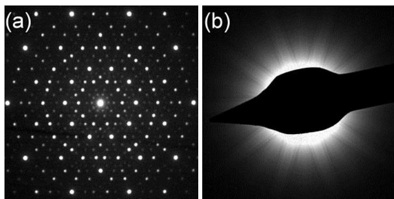
Slika 2.3. Elektronska difrakcije na uzorku prirodno prisutnog  $\text{Al}_{71}\text{Ni}_{24}\text{Fe}_5$  dekagonalnog kvazikristala (pričaznog na slici 1.1), u smjeru okomitom na kvaziperiodične ravnine [1].
