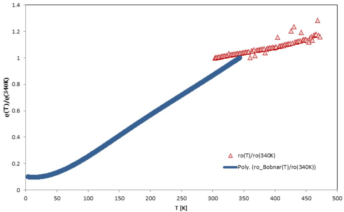
Slika 4.2. Graf električne otpornosti  $d$ -AlCoNi u ovisnosti o temperaturi skaliran na vrijednost otpornosti na 340K. Plava linija predstavlja dosadašnja mjerena te je dobivena interpolacijom polinoma kroz točke dobivene digitizacijom grafa iz [2] koristeći alat WebPlotDigitizer [11]. Crvena linija predstavlja rezultate ovog rada.
