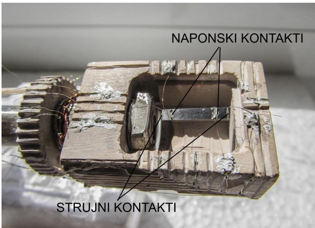
Slika 3.2. Uzorak  $d$ -AlCoNi montiran na nosač. Na uzorak su spojene dvije struje i dvije naponske žice koje su potom spojene na predvidena kontaktna mesta na nosaču.
