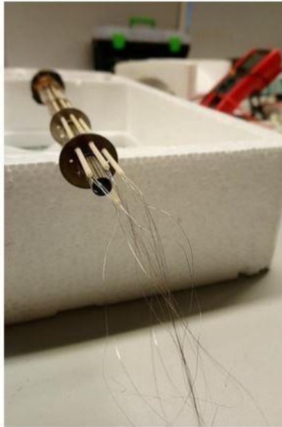
Slika 2.2: Nosač sa keramičkim cijevima kroz koje su provučeni vodiči od platine. Slika preuzeta iz ref. [3], fotografirano u laboratoriju PMFST-a.
