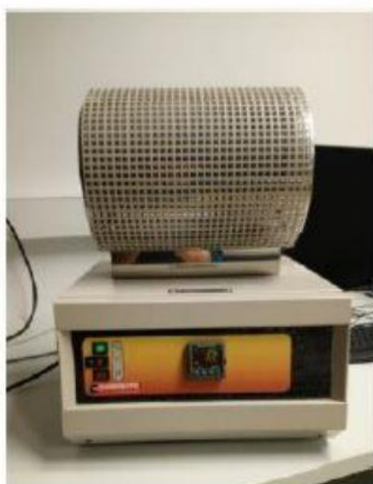
Slika 2.1: Carbolite Gero MTF 12/38/250 peć sa Eurotherm programatorom. Slika preuzeta iz ref. [3], fotografirano u laboratoriju PMFST-a.
