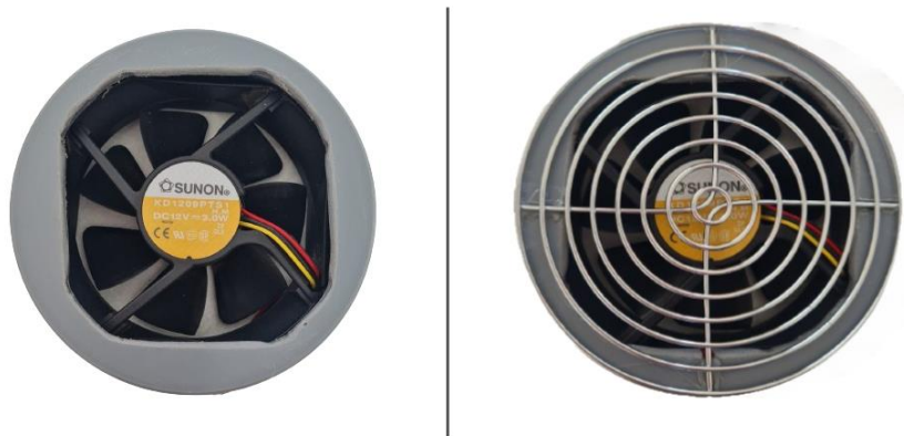
Slika 12 Spajanje poklopca cijevi s ventilatorom i zaštitnom rešetkom
