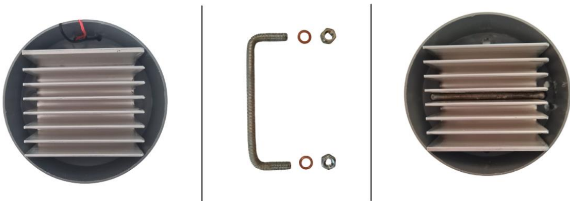
Slika 11 Fiksiranje hladnjaka navojnom šipkom
