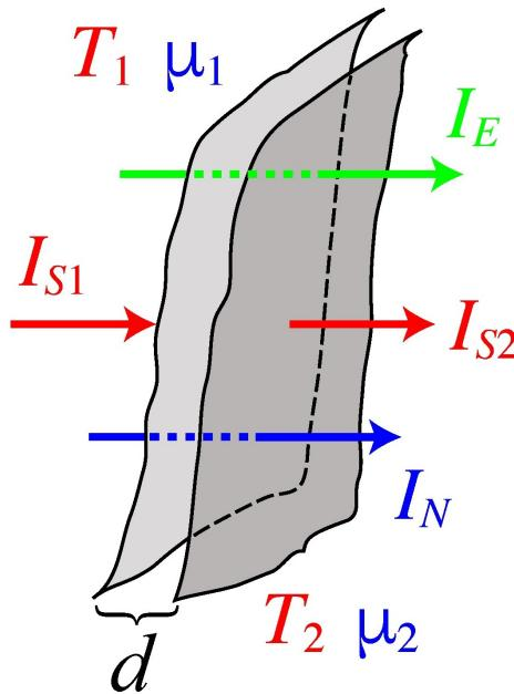
**Slika 1:** Protjecanje struje  $I_E = \text{const.}$ , nošene strujama entropije  $I_S \neq \text{const.}$  i broja čestica  $I_N = \text{const.}$ , kroz dva elementa površine različitih temperatura  $T_1$  i  $T_2 \lesssim T_1$  i različitih elektrokemijskih potencijala  $\bar{\mu}_1$  i  $\bar{\mu}_2 \lesssim \bar{\mu}_1$  [3]
