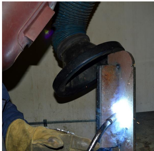
Slika 3: Zavarivanje MAG postupkom[8]
