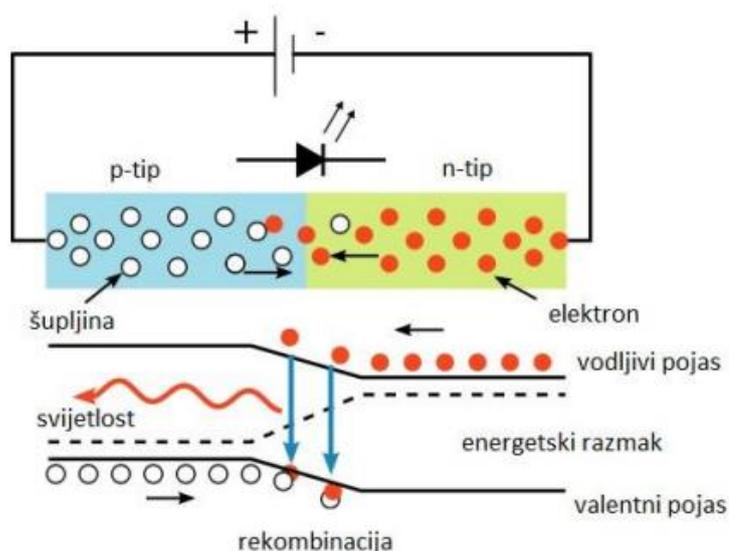
Slika 4.5 Generiranje svjetlosti kod LED dioda [25]
