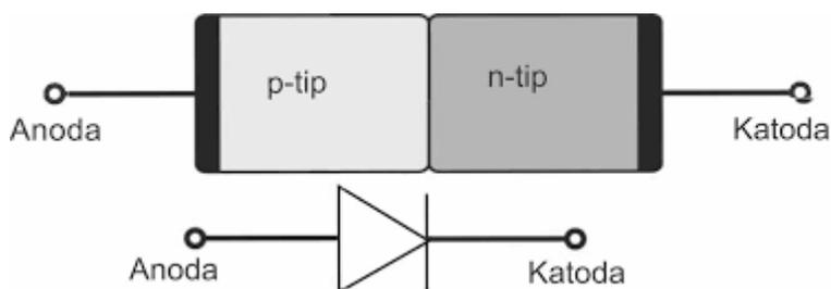
Slika 1.1 Opća konstrukcija i simbol diode [40]
