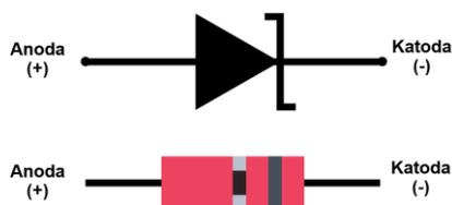
Slika 4.1 Simbol i primjer fizičke izvedbe Zener diode [23]
