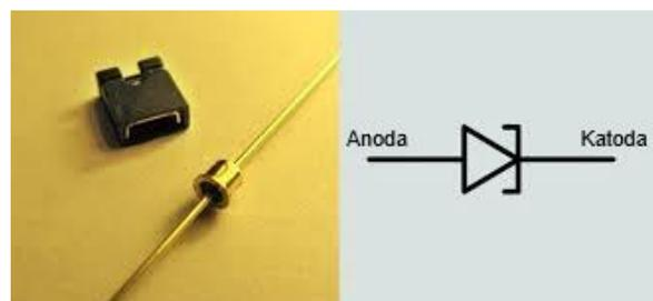
Slika 4.10 Izgled i simbol tunel diode [33]
