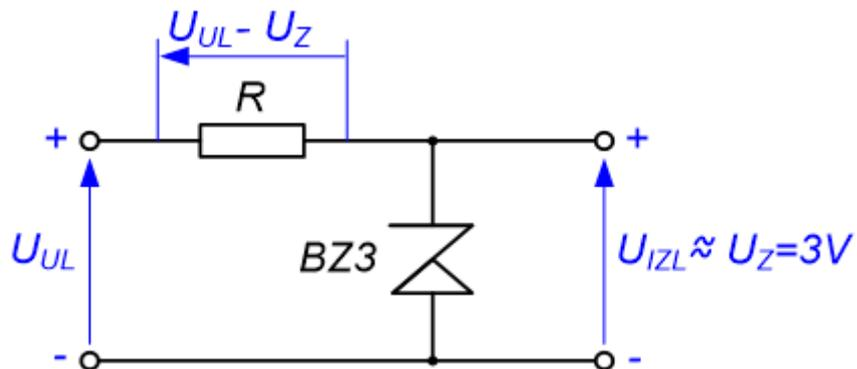
Slika 4.3 Jednostavni stabilizator napona sa Zener diodom [8]
