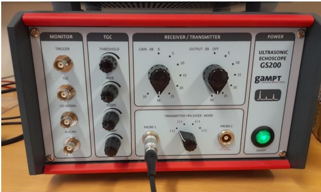
Slika 3. Upravljačka ploča ultrazvučnog ehoskopa GS2000
