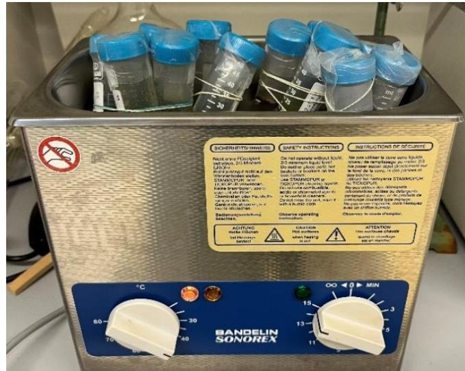
**Slika 7.** Ultrazvučna kupelj na 40°C
