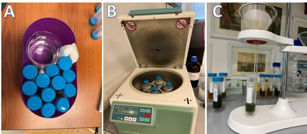
**Slika 8.** A- uzorci pripremljeni za maceraciju; B- centrifugiranje; C- filtriranje uzorka nakon maceracije
