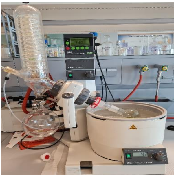
Slika 13. Uparavanje rotavaporom (izvor: vlastita izrada)
