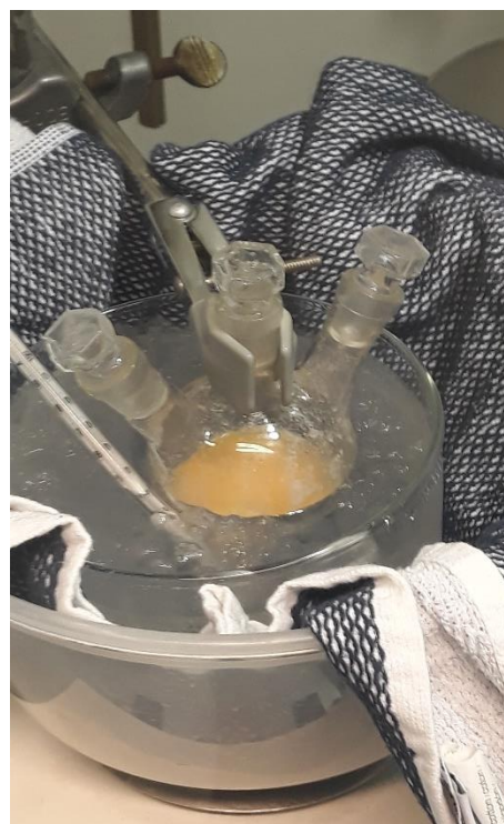
Slika 10: Reakcijska smjesa nakon dodatka cijele otopine broma
