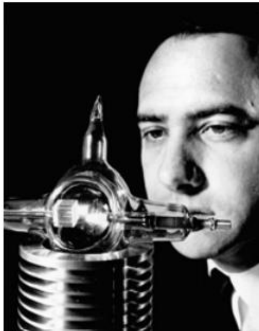
Slika 2.1 Theodore H. Maiman sa kristalom rubina - centralnim dijelom prvog lasera. (slika preuzeta s [2])
