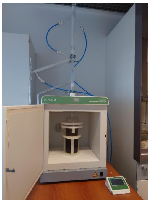
Slika 10. Unutrašnjost uređaja za mikrovalnu ekstrakciju
