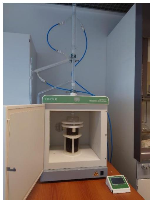
Slika 10. Unutrašnjost uređaja za mikrovalnu ekstrakciju
