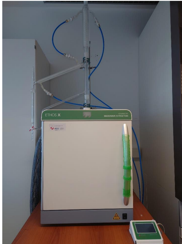
Slika 9. Prikaz uređaja za mikrovalnu ekstrakciju eteričnih ulja (Ethos X)
