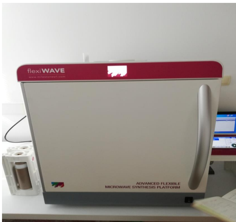
Slika 4. Mikrovalna peč korištena za sintezu
