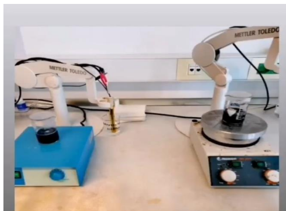
Slika 7. Uzorci na magnetskoj miješalici
