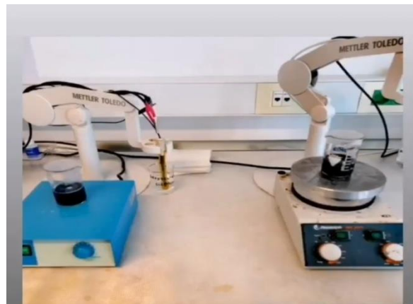
Slika 7. Uzorci na magnetskoj miješalici
