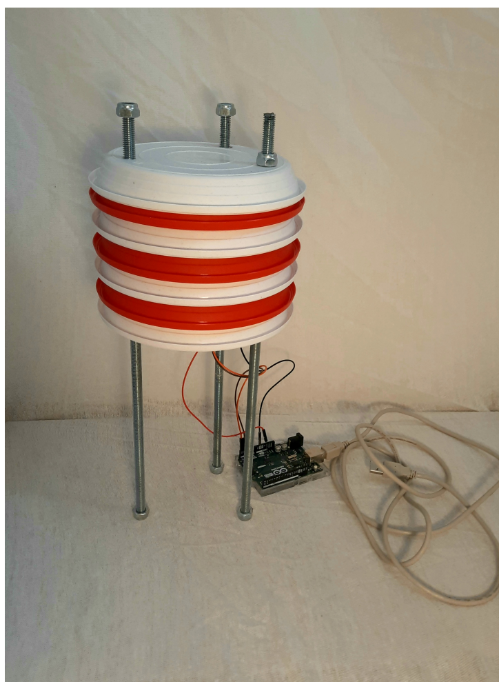
Slika 8: Završeno kućište meteorološke postaje (izvor: autor)
