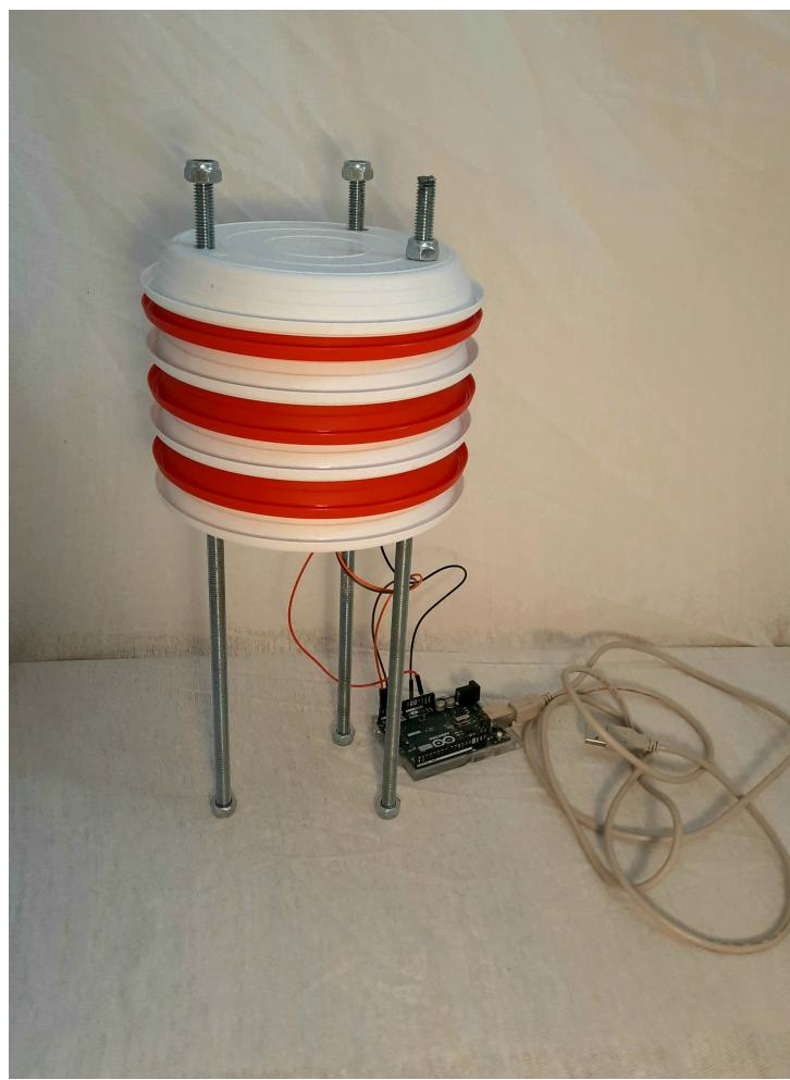
**Slika 8:** Završeno kućište meteorološke postaje (izvor: autor)
