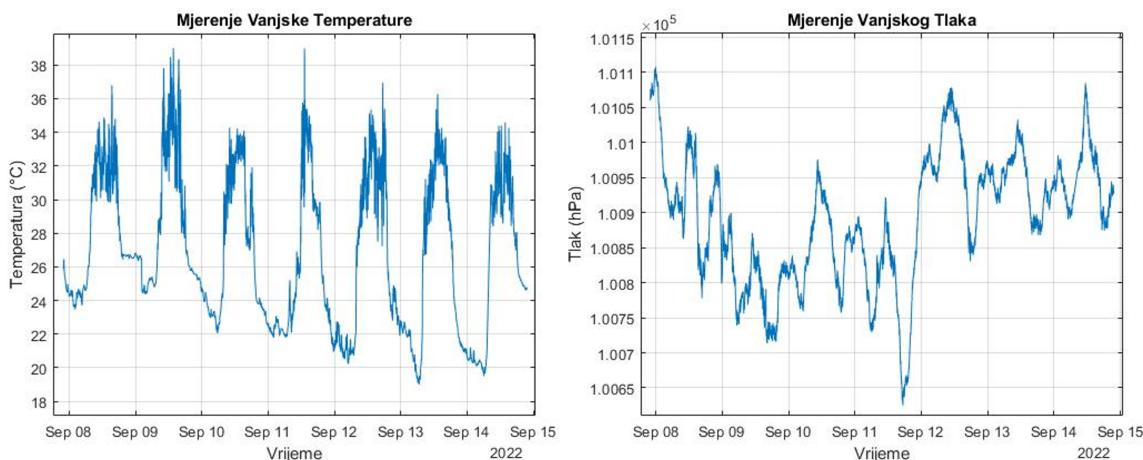
**Slika 17:** Vremenski nizovi vanjske temperature (lijevo) i tlaka (desno) zraka izmjereni Arduino meteorološkom postajom (izvor: autor)
