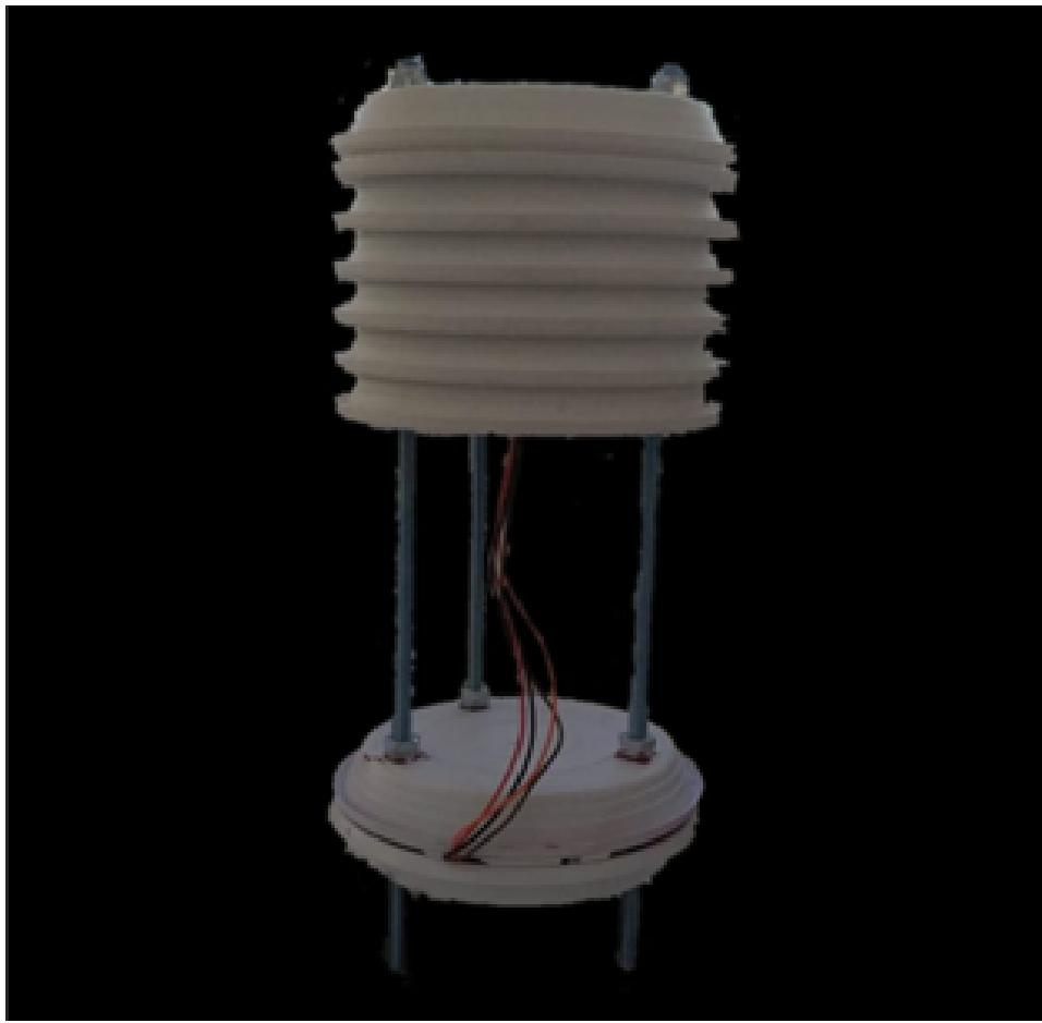
**Slika 15:** Modificirana Arduino meteorološka postaja (izvor: autor)
