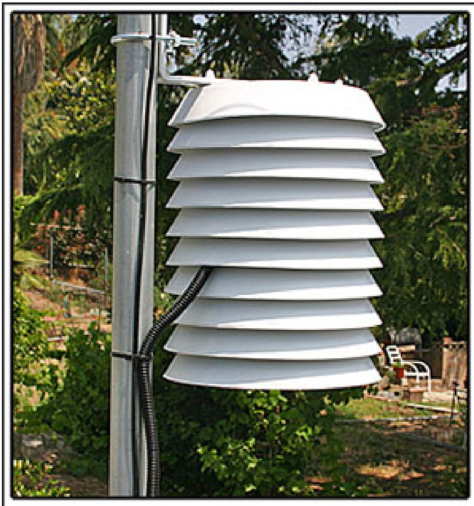
**Slika 2:** Varijanta Stevensovog zaklona izgrađena od plastičnih tanjurića obojanih u bijelu boju . (preuzeto s: [https://pljusak.com/img/site/zaklon\\_plastik.jpg](https://pljusak.com/img/site/zaklon_plastik.jpg))
