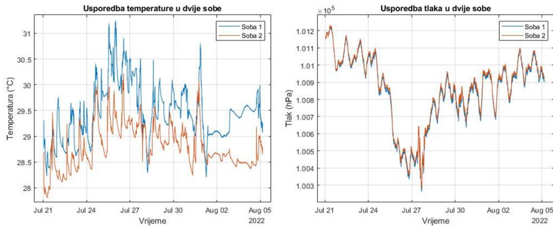
**Slika 16:** Vremenski nizovi sobne temperature (lijevo) i tlaka (desno) izmjereni Arduino meteorološkom postajom (izvor: autor)
