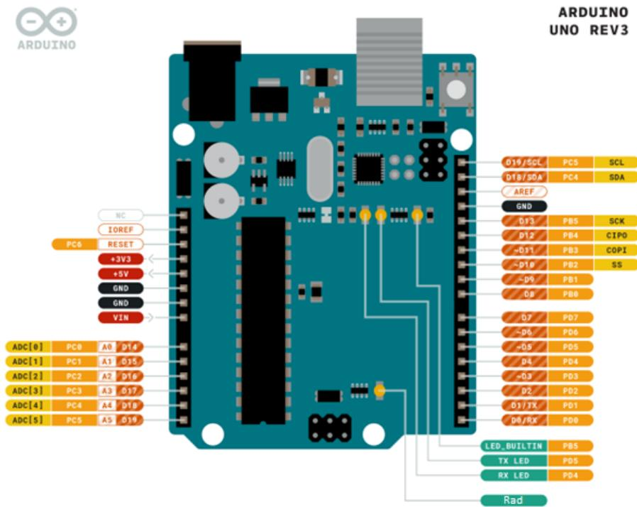
**Slika 3:** Shematski prikaz Arduino UNO-a. (slika preuzeta s [9])
