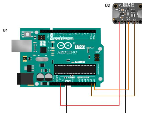
**Slika 5:** Shematski prikaz spajanja Arduino UNO-a (U1) s BMP280 senzorom (U2) (izvor: autor)
