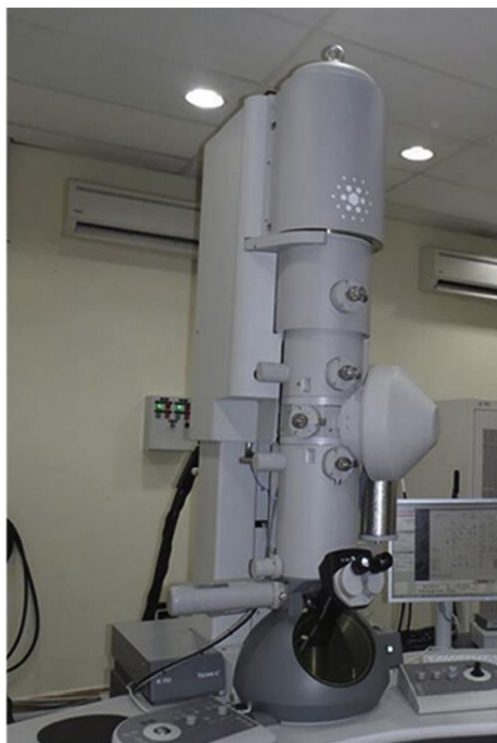
Slika 2 Transmisijski elektronski mikroskop novije građe (Tang i Yang, 2017)
