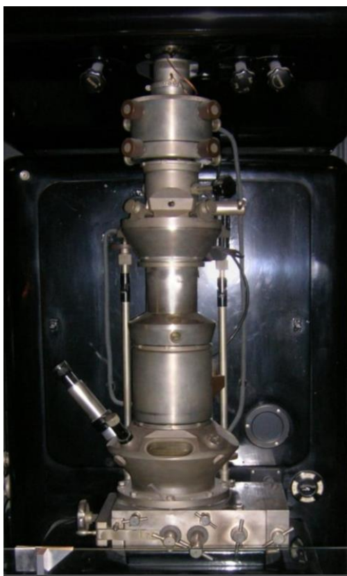
Slika 1 Prototip elektronskog mikroskopa 1933. godine (Lalchandama, 2020)
