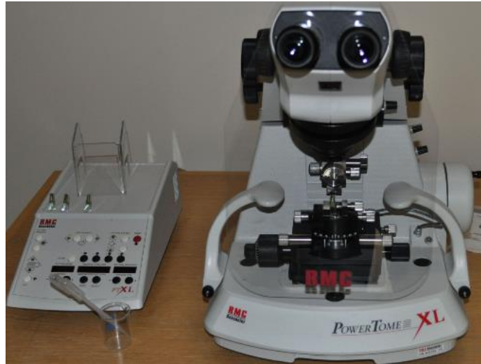
Slika 6 Ultramikotom (Utah State University)
