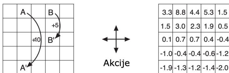
Slika 1.2: Mrežni svijet: dinamika nagrada (lijevo) i vrijednosna funkcija stanja (desno) pri korištenju strategije s jednakom vjerojatnošću kretanja u sva četiri smijera [1]
