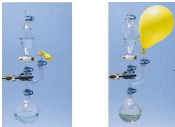
Slika 9. Kataliza raspada \text{H}_2\text{O}_2 uz \text{I}^- kao katalizator 4
