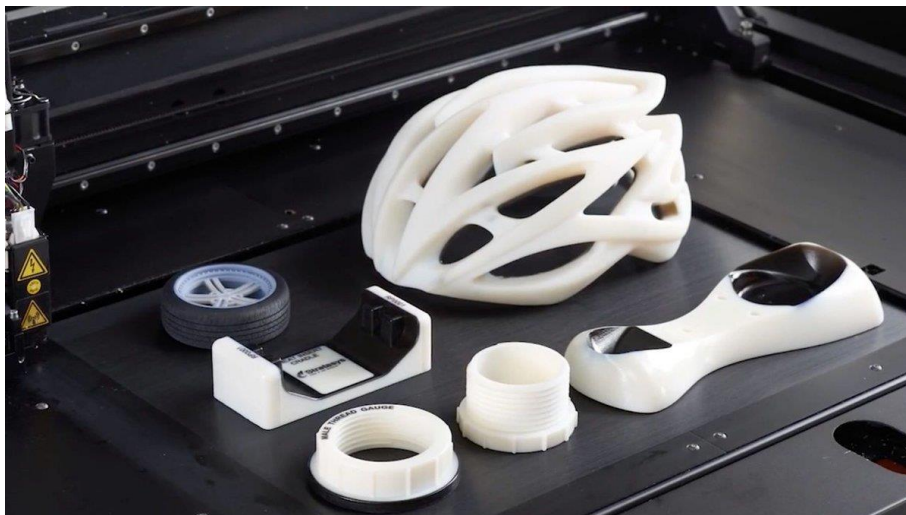
Slika 2.7. Modeli izrađeni PolyJet tehnologijom [11]
