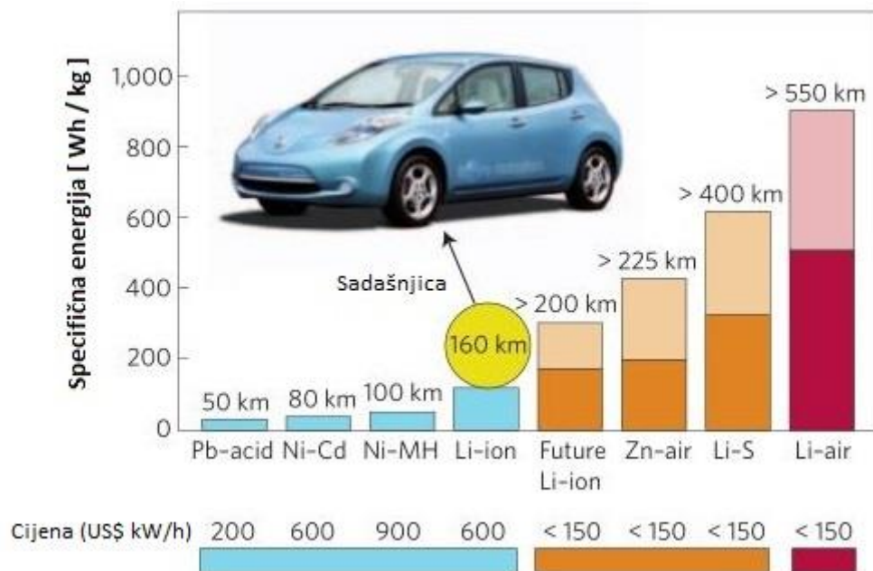
Slika 5. Gustoće energije za neke punjive baterije buduće tehnologije, uz procjenu pređene udaljenosti automobilom i cijenu pakiranja energije od 1 kW/h odnosno 1 J. Vrijednosti dometa su skalirane prema poznatim vrijednostima gustoće energije Li-ion ćelija (140 Wh /kg) i dometu od 160 km za automobil Nissan Leaf; (slika preuzeta iz [3])
