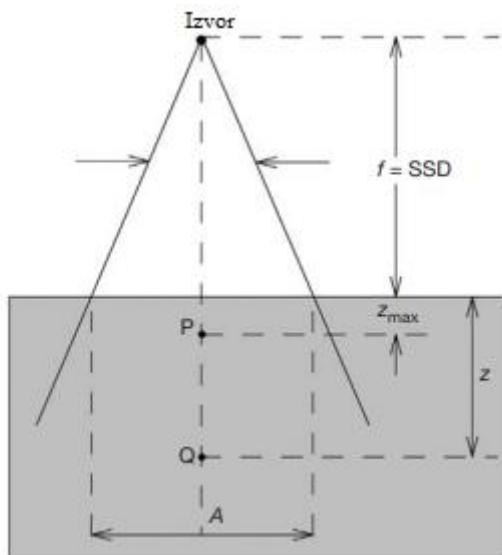
**Slika 13.** Geometrija za izračun postotne dubinske doze. A označava veličinu polja, P referentnu točku na dubini  $z_{max}$ , Q proizvoljnu točku na dubini  $z$ . SSD označava udaljenost izvora od površine. (Preuzeto iz [11])
