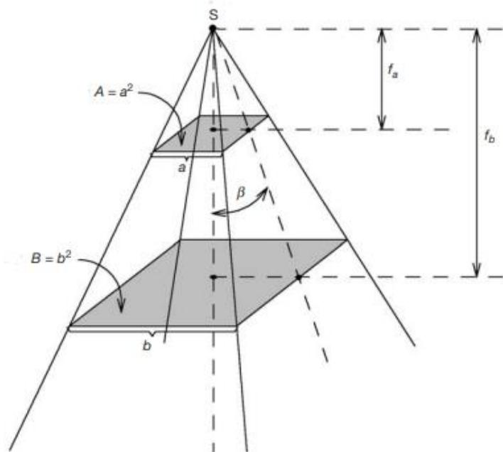
**Slika 10.** Snop fotona nastao iz točkastog izvora fotona. Na slici, S označava izvor fotona, A je površina kvadratnog polja stranice  $a$ , a B je površina kvadratnog polja stranice  $b$ ,  $\beta$  predstavlja kut između središnje osi snopa i geometrijskog ruba snopa,  $f_a$  i  $f_b$  su udaljenosti kvadratnih polja  $a$  i  $b$  od izvora. (Preuzeto iz [11]).
