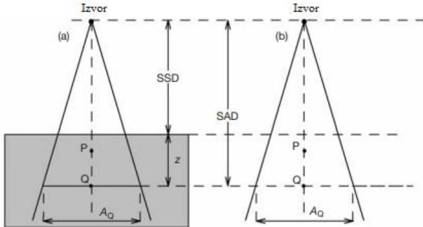
**Slika 15.** Geometrija za mjerjenje omjera tkivo-zrak.  $A_Q$  predstavlja veličinu polja u točki  $Q$ , pod a) prikazano je određivanje doze u točki  $Q$  u fantomu, a pod b) određivanje doze na malu masu vode u točki  $Q$ . SSD predstavlja udaljenost izvora od površine,  $z$  je dubina proizvoljne točke  $Q$  u fantomu, a SAD je izocentrična postavka udaljenosti izvora do proizvoljne točke  $Q$ . (Preuzeto iz [11])
