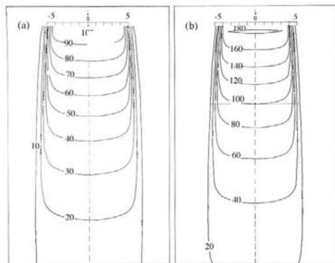
**Slika 19.** Primjer izodozne krivulje za snop  $^{60}\text{Co}$  u vodi. Pod a) prikazan je SSD postav s parametrima  $A = 10 \text{ cm} \times 10 \text{ cm}$ ,  $\text{SSD} = 80 \text{ cm}$ , pod b) prikazan je SAD postav s parametrima  $A = 10 \text{ cm} \times 10 \text{ cm}$ ,  $\text{SAD} = 100 \text{ cm}$ , dubina izocentra = 10 cm. (Preuzeto iz [11])
