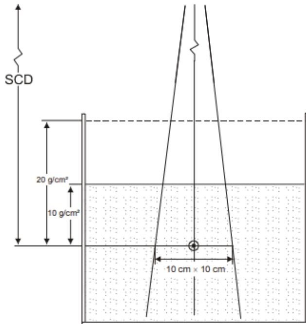
**Slika 16.** Prikaz geometrijskog postava za određivanje kvalitete snopa ( $TPR_{20,10}$ ). SCD predstavlja udaljenost izvora do komorice, veličina polja postavljena je na  $10 \text{ cm} \times 10 \text{ cm}$ . (Preuzeto iz [12])
