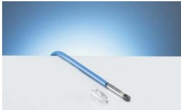
**Slika 8.** Ionizacijska komora PTW Semiflex 31010. (Preuzeto s <http://ptwdosimetry.com> [8])
