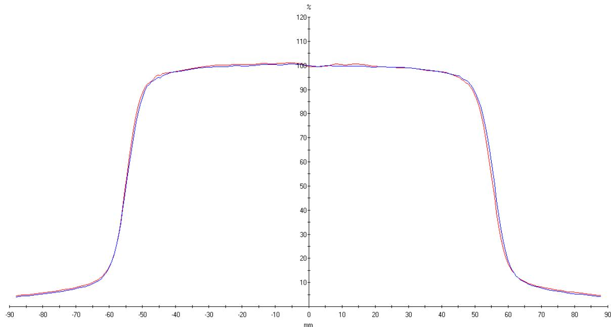
**Slika 29.** Na slici su prikazani profili fotonskih snopova za energiju 6 MV za polje veličine 10 cm x 10 cm. Krivulje crvene i plave boje prikazuju „inplane“ i „crossplane“ profil snopa. Na x-osi označena je udaljenost od središnje osi izražena u milimetrima, a na y-osi je označena doza u postotcima. SSD je 100 cm.
