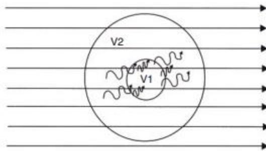
**Slika 6.** Princip zrak-zid. Na slici je prikazan manji volumen označen s V1 kojeg okužuje veći volumen V2, te su izloženi istom polju zračenja. (Preuzeto iz [9])
