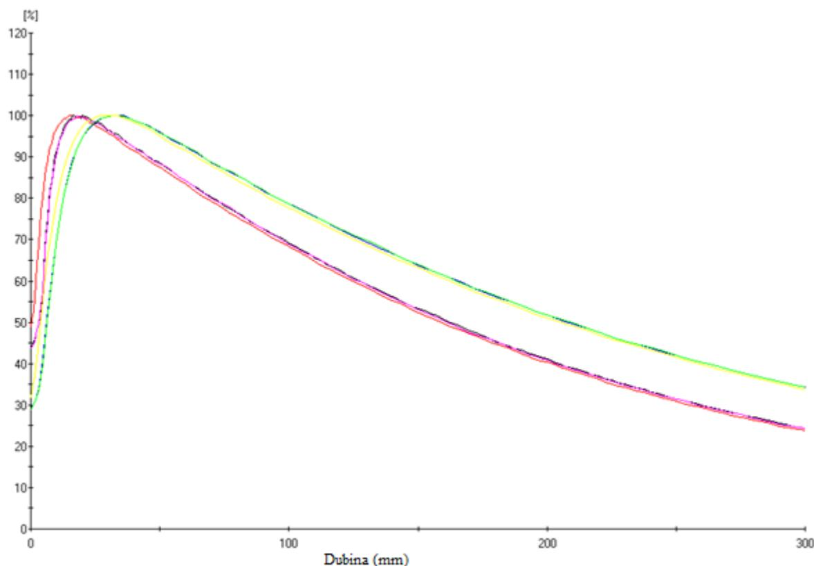
*Slika 25.* Na slici su prikazane izmjerene PDD krivulje fotonskih snopova za energije 6 MV i 18 MV. Crvena, crna i ljubičasta krivulja predstavljaju izmjerene PDD krivulje za fotonski snop energije 6MV, a žuta, zelena i plava krivulja predstavljaju izmjerene PDD krivulje za fotonski snop energije 18 MV. Na x-osi označena je dubina izražena u milimetrima, a na y-osi je označena doza u postotcima. Veličina polja je 20 cm x 20 cm, a SSD iznosi 100 cm.
