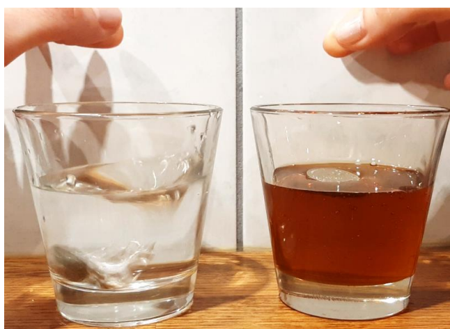
Slika 10. Pokus 2. Fotografija je uhvaćena trenutak poslije ispuštanja novčića u med. Vidi se da je novčić u vodi taman potonuo, dok novčić u medu još nije ni počeo tonuti.
