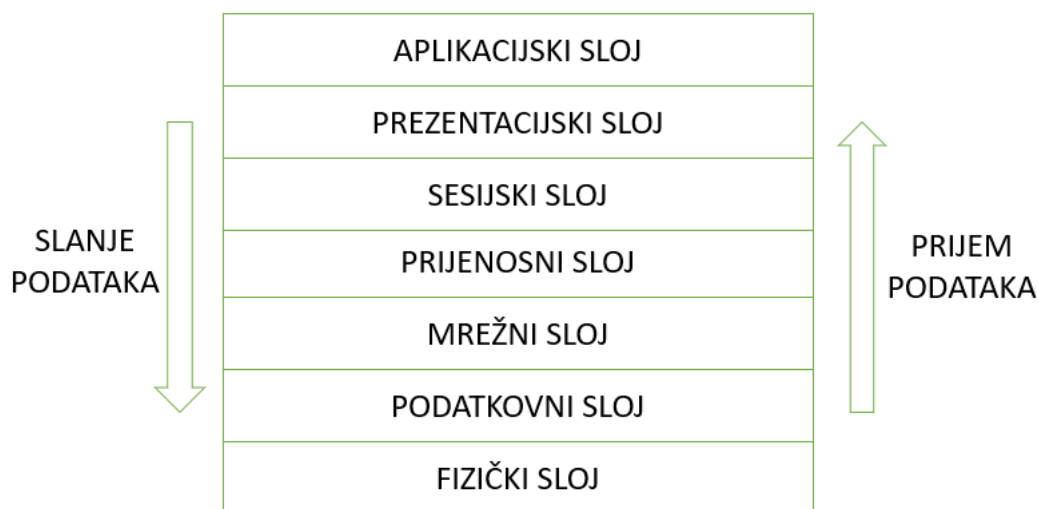
Slika 3.1: Prikaz sedam slojeva OSI modela
