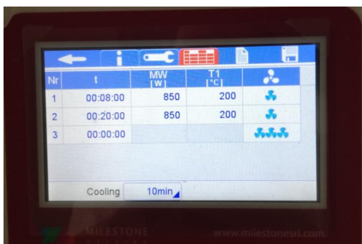
Slika 6. Mikrovalni program za sintezu čestica hematita
