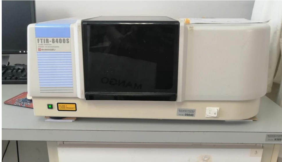
Slika 9. FTIR uređaj korišten za analizu uzorka
