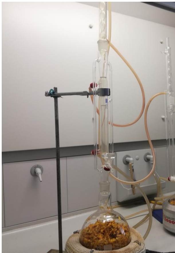
Slika 8. Aparatura za hidrodestilaciju eteričnog ulja brnistre
