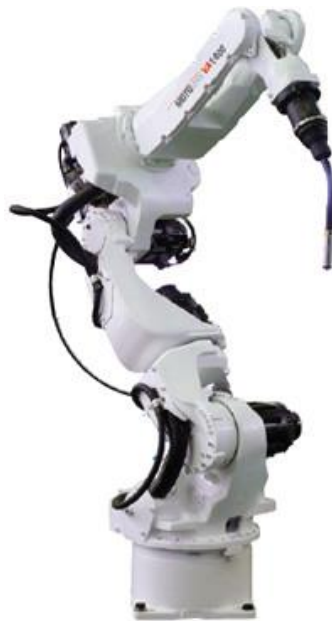
Slika 5.9. Sedmoosni robot za zavarivanje [9]
