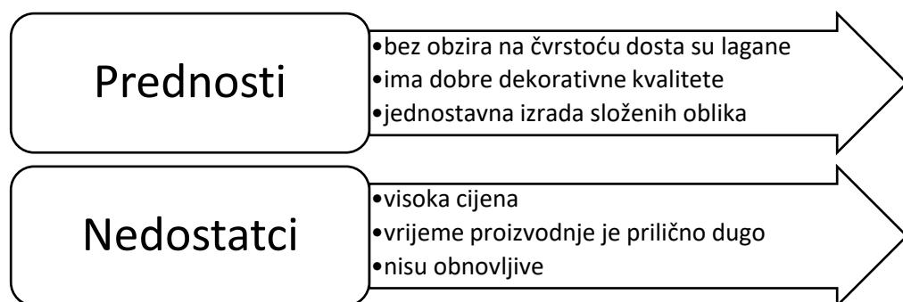
Slika 3.5. Prednosti i nedostatci plastike ojačanom staklenim vlknima [5]
