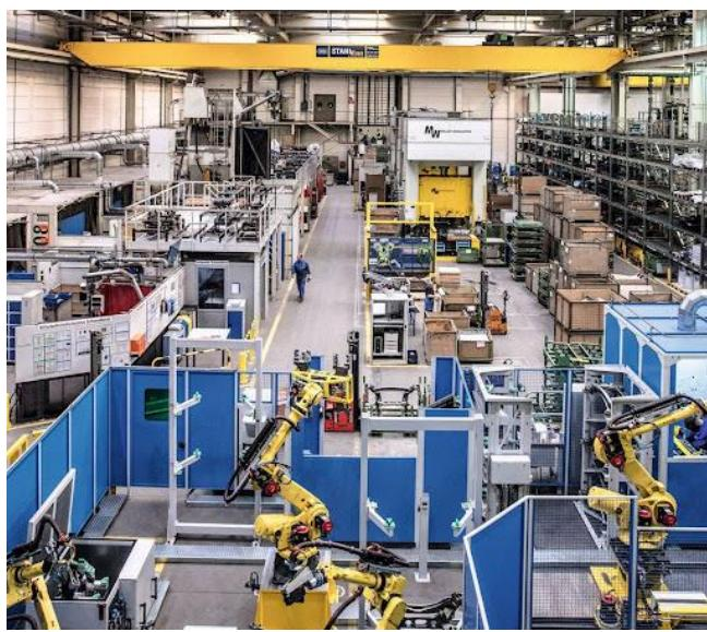
Slika 5.10. Zavarivanje s šestoosnim robotom [9]
