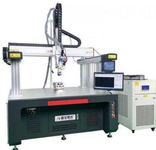
Slika 4.18. Uređaj za lasersko zavarivanje [9]
