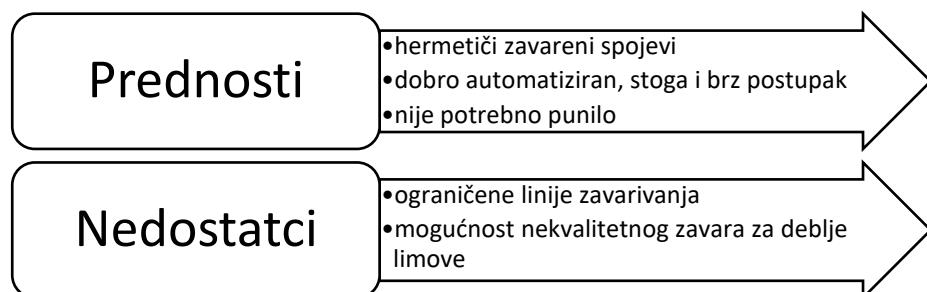
Slika 4.8. Prednosti i nedostatci šavnog zavarivanja [9]
