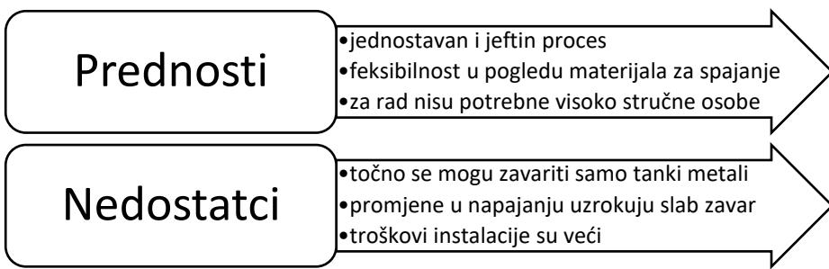
Slika 4.4. Prednosti i nedostatci točkastog zavarivanja [9]
