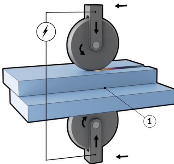
Slika 4.6. Shema šavnog zavarivanja [9]
