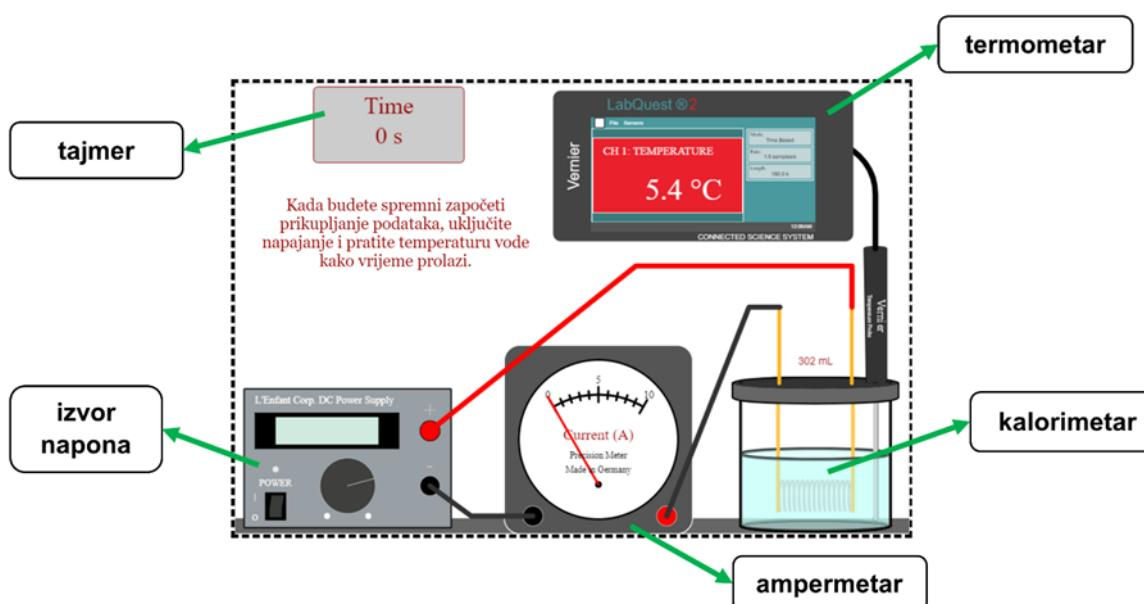
*Slika 3.2 Aparatura za mjerjenje snage grijajuća. Aparatura se sastoji od izvora napona koji generira 5 različitih napona, kalorimetra s vodom čiji se obujam također može postaviti na 5 različitih vrijednosti, tajmera koji mjeri vrijeme zagrijavanja, ampermetra koji mjeri električnu struju te termometra koji mjeri temperaturu vode.*
