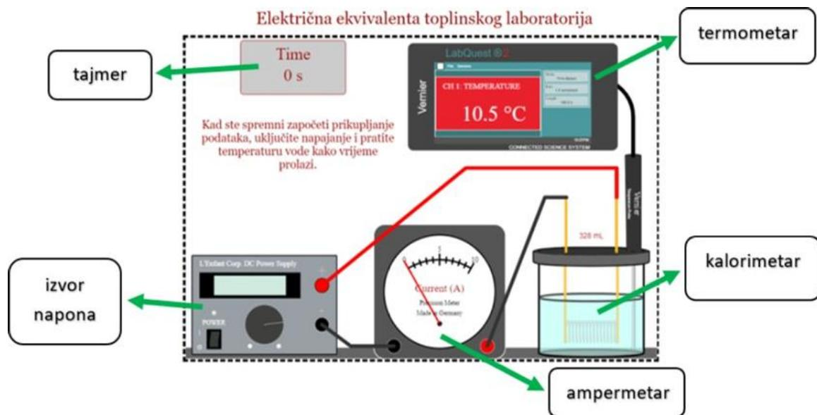
*Slika 6.1 Aparatura za mjerjenje s naznačenim dijelovima uređaja.*
