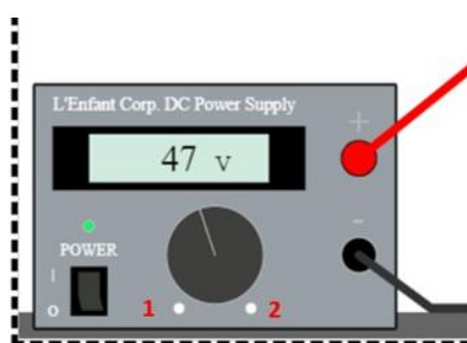
Slika 6.2 Izvor napona. Crvenim brojevima 1 i 2 označene su tipke kojima se mijenja napon izvora.
