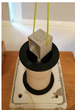
Slika 44. Uteg od 200 mg postavljen na nosač tereta.
